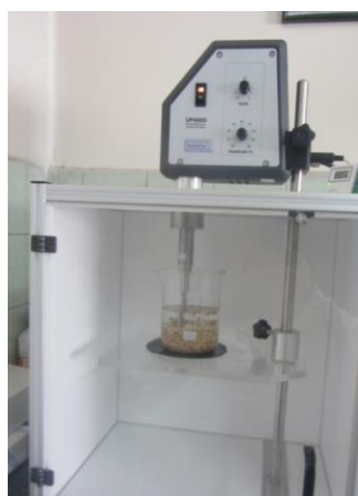
شکل ۲. دستگاه تولیدکننده امواج فراصوت
