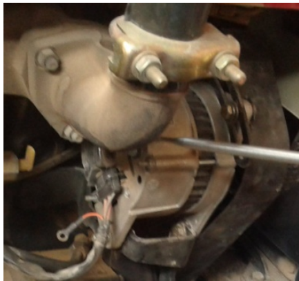
شکل ۴. نحوه قرارگیری پروپ حسگر روی بدنه آلترناتور
