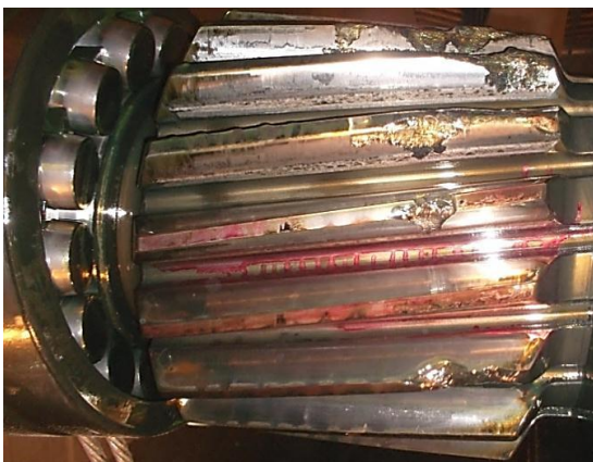
شکل ۹. تصویر خرابی چرخ‌دنده محور میانی
