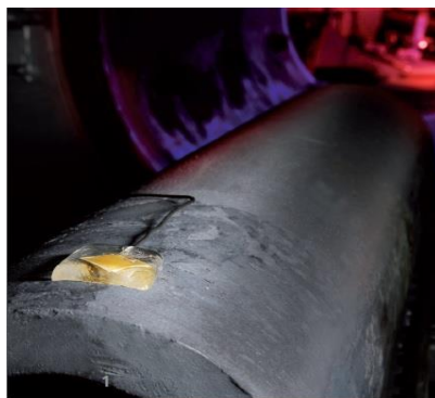
شکل ۱۸. حسگر پیزوالکتریک قرارداده شده روی سازه [۲]
