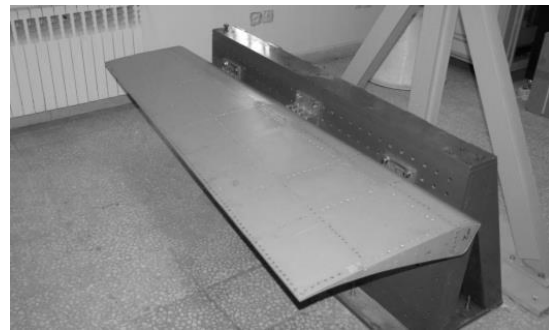
شکل ۶. نمایی از نحوه اتصال ایلرون به فیکسچر آزمون
