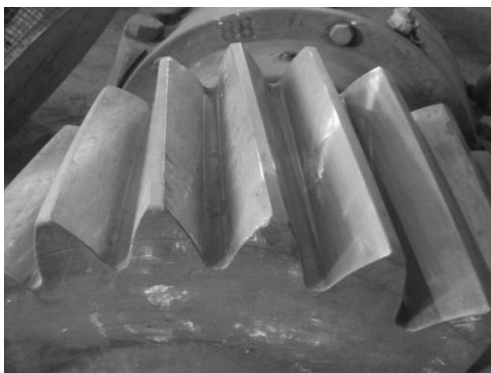
شکل ۴. تصاویری از پینیون با دنده‌های سایید شده: بالا و دنده سالم: پایین
