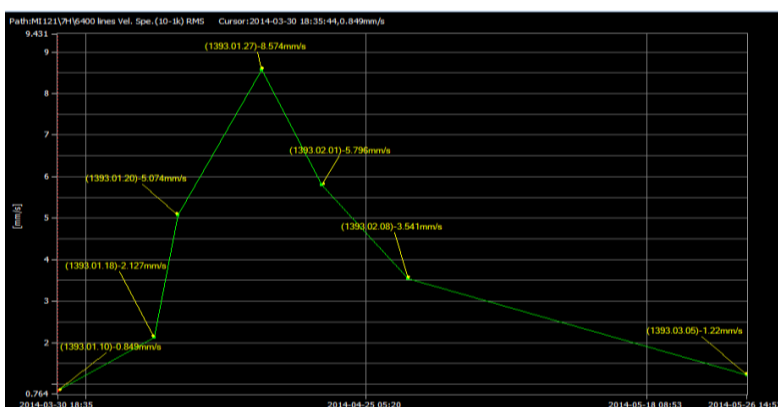
شکل ۲. نمودارهای ترند دامنه ارتعاشی نقطه داده‌برداری ۷ در راستاهای محوری: بالا، عمودی؛ وسط و افقی: پایین
