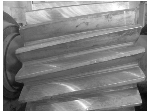
شکل ۴. تصاویری از پینیون با دنده‌های سایید شده: بالا و دنده سالم: پایین
