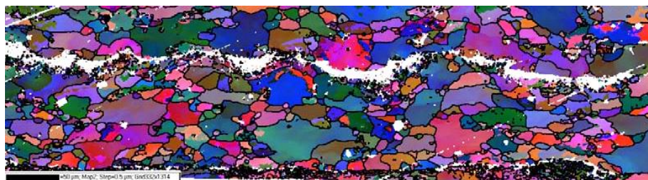
شکل ۴. تصویر تفرق الکترون برگشتی از محل اتصال دو فویل [۹]
