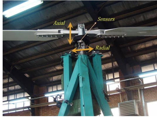
شکل ۸. تست ارتعاشی روتور در حالت استاتیکی
