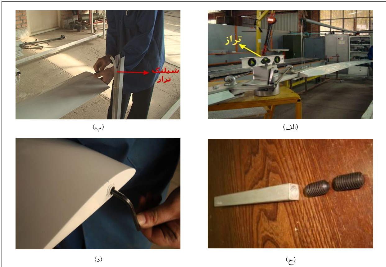
شکل ۱۱. مراحل آزمایش تراز و تنظیم پره‌ها
