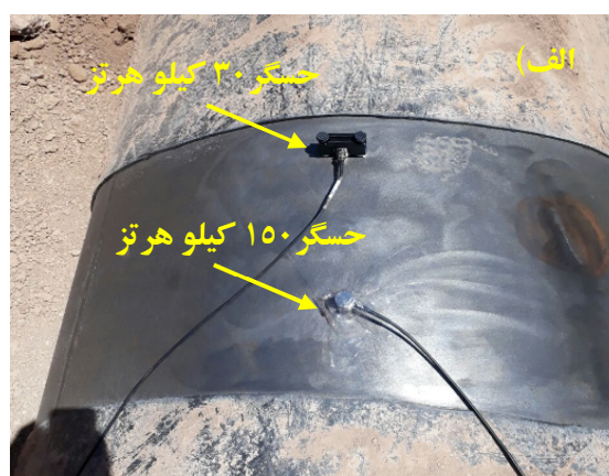
شکل ۳. محل قرارگیری حسگرها بر روی لوله الف) حسگر ۳۰ کیلو هرتز شماره ۱ ب) حسگر ۳۰ کیلو هرتز شماره ۲
