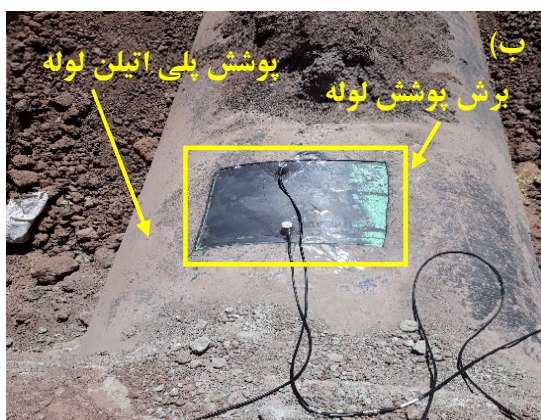
شکل ۳. محل قرارگیری حسگرها بر روی لوله الف) حسگر ۳۰ کیلو هرتز شماره ۱ ب) حسگر ۳۰ کیلو هرتز شماره ۲
